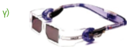
Εικόνα 6: Ειδικά γυαλιά για στερεοσκοπική όραση: α) Γυαλιά μπλε-κόκκινων φακών, β) Γυαλιά με αντίθετα πολωμένους φακούς, γ) Γυαλιά LCD, δ) HMD
