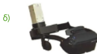
Εικόνα 6: Ειδικά γυαλιά για στερεοσκοπική όραση: α) Γυαλιά μπλε-κόκκινων φακών, β) Γυαλιά με αντίθετα πολωμένους φακούς, γ) Γυαλιά LCD, δ) HMD
